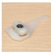
Con il freddo l'alluminio si contrae più del legno. Ciò crea tensione sul telaio. Per contrastare questo fenomeno, montiamo il rivestimento in alluminio su giunti scorrevoli - come su un sistema a binario.
